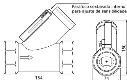
A passagem do fluido pelo sensor provoca o deslocamento preciso do pistão magnético que atua sobre um contato Reed Switch.
